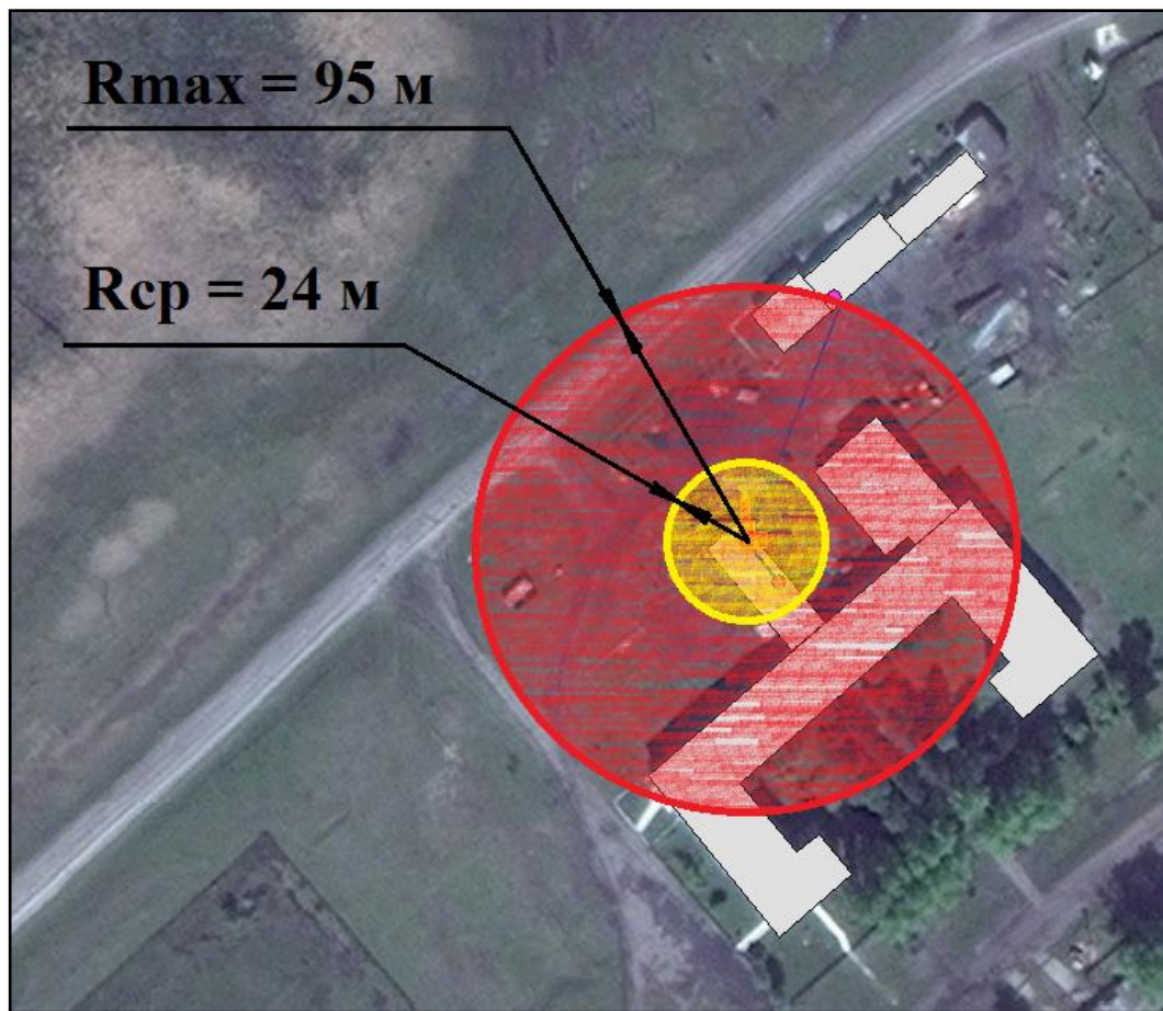
Рисунок II-1.2. Средний и максимальный радиусы теплоснабжения в зоне действия котельной МУП «Новосилишинское ЖКХ»
